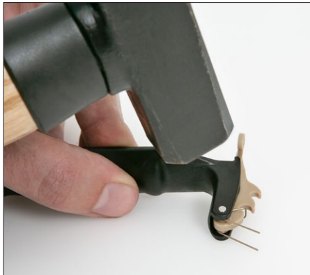
Bolzen mit Hammer vollständig eintreiben – Beschädigungen vermeiden.
